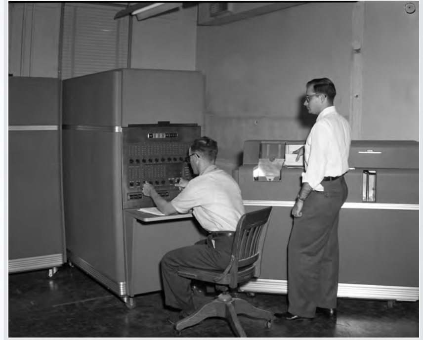
IBM 650 1954 г. вес 900 кг, блок питания - вес 1 350 кг $ 4 млн.
